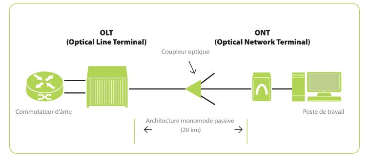
Le terminal de ligne optique (OLT) réside dans le centre de données du réseau d'âmes. Il se connecte au switch d'âme en utilisant la connectique traditionnelle d'âme Ethernet.
